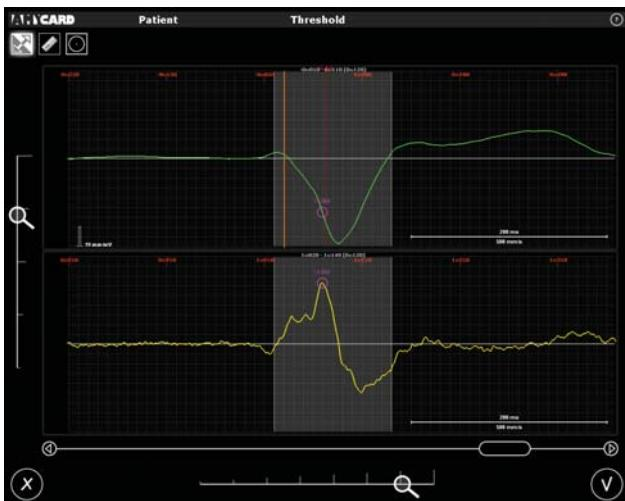
*Рис. 1. Определение момента активации миокарда по времени внутреннего отклонения униполлярной электрограммы. Вверху - униполлярная электрограмма, внизу ее - первая отрицательная производная по времени. Время внутреннего отклонения определяется как глобальный максимум первой отрицательной производной униполлярной электрограммы (отмечен кружком).*
