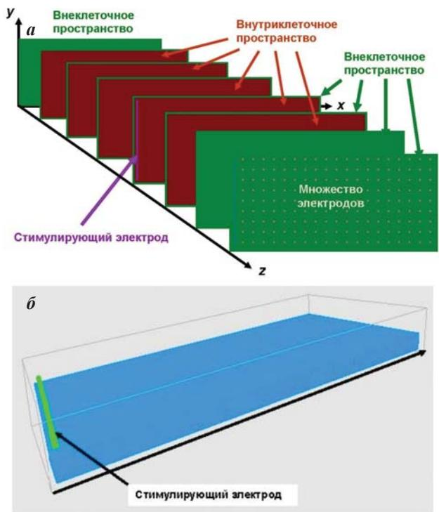
*Рис. 2. Модель «субстрата» миокарда, имеющая многослойную структуру - квази 3D-модель. Панель (а) - параллельные внутриклеточные и внеклеточные слои, а также множество электродов в произвольных внеклеточных слоях для «измерения» потенциала действия клеток миокарда. Панель (б) - общий вид субстрата со стимулирующим электродом, создающим плоский фронт возбуждения в направлении оси x.*
