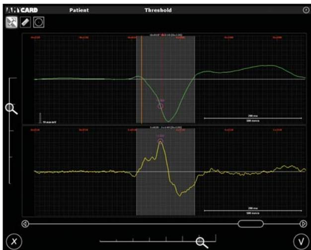
Рис. 1. Определение момента активации миокарда по времени внутреннего отклонения униполярной электрограммы. Вверху - униполярная электрограмма, внизу ее - первая отрицательная производная по времени. Время внутреннего отклонения определяется как глобальный максимум первой отрицательной производной униполярной электрограммы (отмечен кружком).
